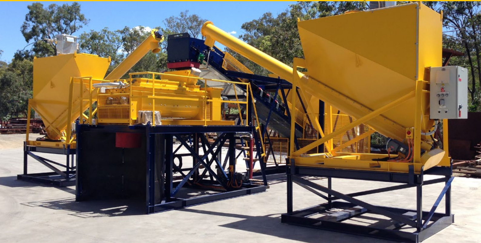
80 tonnes per hour mortar / paste pugmill
